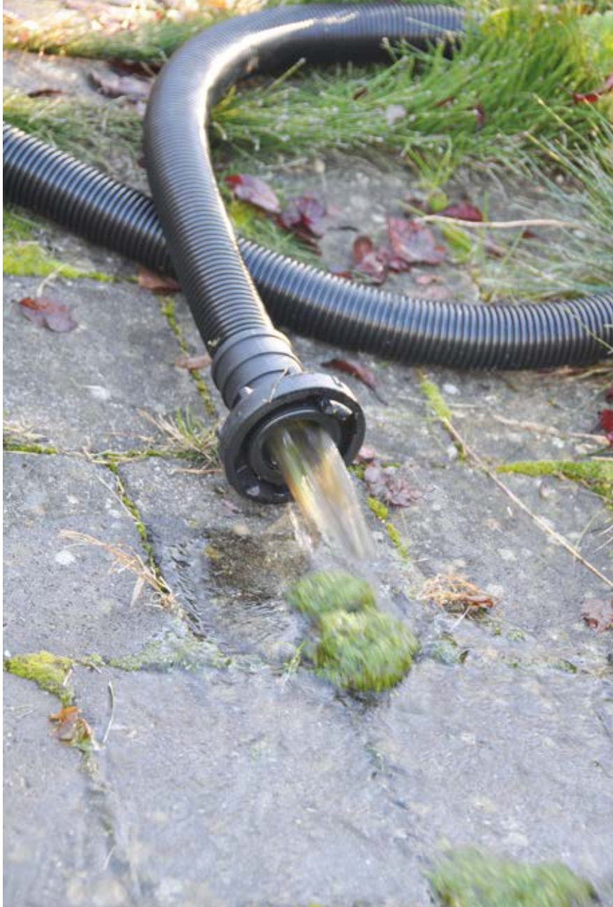
▲ Rückspielleitungen sind ein Muss, um Schmutzpartikel aus dem Substratfilter entnehmen zu können.
