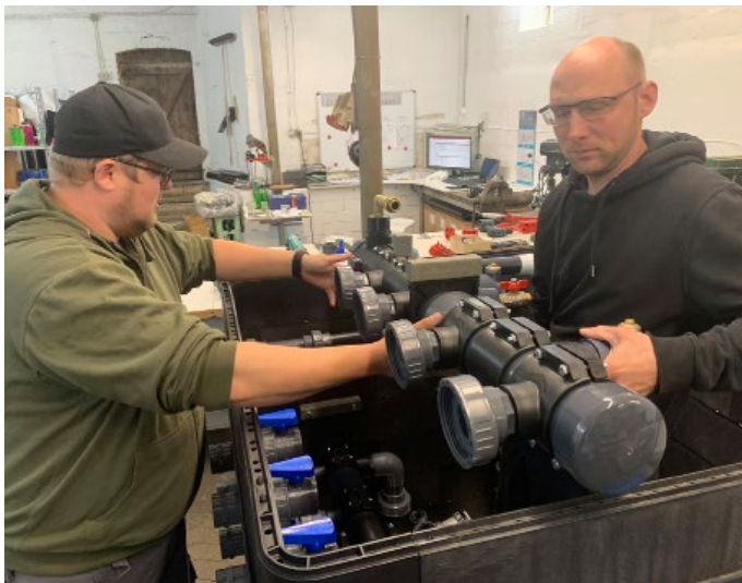
Kevin Dehne und Reno Hottenbach bauen die Technikschrächte für Naturpools zusammen.
