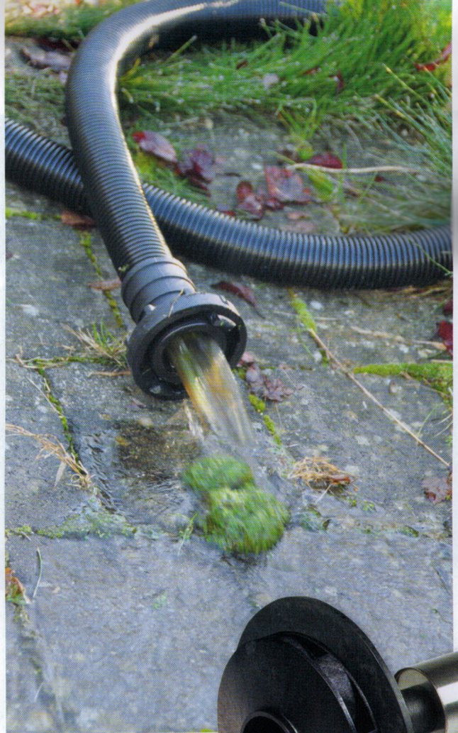
▲ Die Pumpe wird nach der Saison ausgebaut und gereinigt. Besonderes Augenmerk liegt auf der Laufeinheit.
