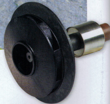
▲ Die Pumpe wird nach der Saison ausgebaut und gereinigt. Besonderes Augenmerk liegt auf der Laufeinheit.
