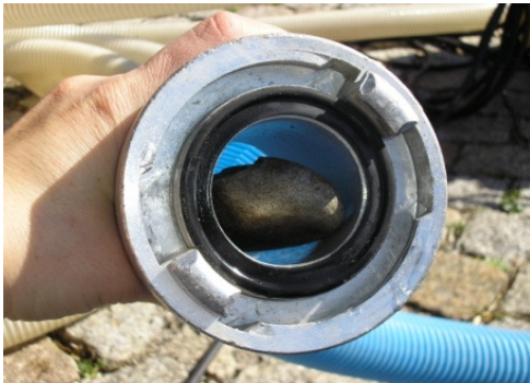
« Bild 5 Stein in der C-Kupplung des Saugschlauches
