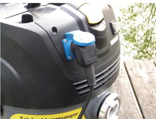
« Bild 3 Stecker der Behälter- entleerungspumpe
