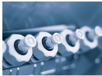
Der Sprühbalken und die hochwertigen Sprühdüsen aus dem Industriebedarf sind mit zwei Handgriffen als komplette Einheit einzeln entnehmbar.
